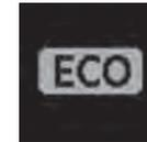
Este indicador se mostrará cuando se logre una conducción eficiente en el consumo de combustible.
