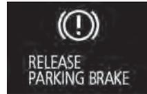
Esta advertencia se muestra si está conduciendo con el freno de estacionamiento aún accionado. La luz de advertencia en el tablero de instrumentos también se enciende cuando el freno de estacionamiento está accionado. Si aparece esta advertencia, baje completamente la palanca del freno de estacionamiento.
