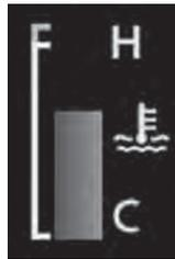
Esto indica la temperatura del refrigerante del motor.
