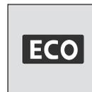
Esta luz indicadora se ilumina cuando se logra una conducción eficiente en el consumo de combustible.
