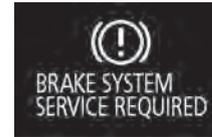
Si el líquido de frenos está bajo cuando el modo de funcionamiento está en ON (Encendido), se muestra esta advertencia.
