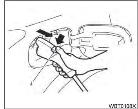
7. Cuando el indicador de carga (G) deja de parpadear, la carga está completa. Extraiga el conector de carga normal mientras presiona el botón de liberación (J).
