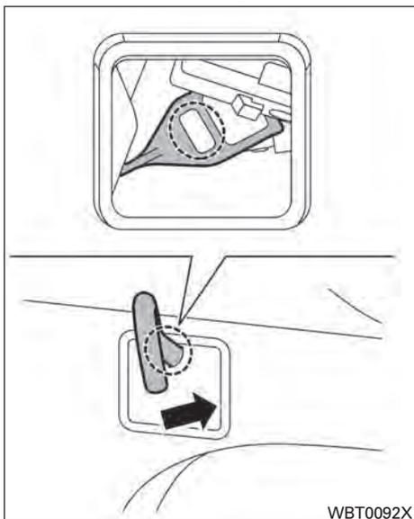
2. Desbloquee la tapa de carga insertando una barra del gato o similar y tirando de la varilla amarilla en la dirección de la flecha.
