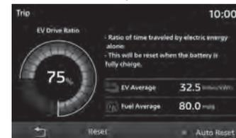
Cada vez que se pulsa [Reinicio automático], esta función cambia entre ON (Encendido) y OFF (Apagado).
