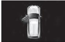
Si alguna de las puertas o la puerta trasera no está completamente cerrada, se muestra la puerta o compuerta trasera abierta. Cuando el interruptor de encendido o el modo de funcionamiento estén en ON (Encendido), si la velocidad del vehículo excede aproximadamente 8 km/h mientras una puerta está entreabierta, suena un timbre cuatro veces. Esto notifica al conductor de que una puerta está entreabierta.
