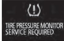
Cada llanta, incluido el repuesto, debe revisarse mensualmente cuando esté frío e inflarse a la presión de inflado recomendada por el fabricante del vehículo en la etiqueta de presión de inflado de las llantas. (Si su vehículo tiene neumáticos de un tamaño diferente al indicado en la etiqueta de presión de inflado de las llantas, debe determinar la presión de inflado correcta para esos neumáticos.)
