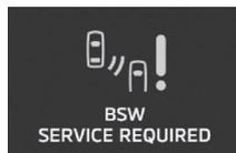
Cuando aparece la pantalla de advertencia, la BSW no funciona normalmente porque hay anomalías en el sistema o en el sensor. Solicite la inspección del vehículo en un distribuidor autorizado de MITSUBISHI MOTORS lo antes posible.
