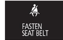
Si el interruptor de encendido se pone en posición “ON” (Encendido) o el modo de funcionamiento se pone en ON mientras el cinturón de seguridad del conductor no está abrochado, se enciende la luz de advertencia y suena la señal acústica durante aproximadamente 6 segundos para recordar al conductor que debe abrocharse el cinturón de seguridad.
