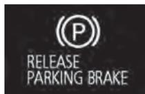
Esta advertencia se muestra si está conduciendo con el freno de estacionamiento aún accionado. La luz de advertencia en el tablero de instrumentos también se enciende cuando el freno de estacionamiento está accionado.
