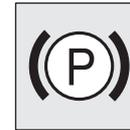
La luz se ilumina cuando se aplica el freno de estacionamiento mientras el interruptor de encendido o el modo de funcionamiento está en ON (Encendido).
