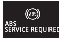
Si hay un mal funcionamiento en el sistema, la luz de advertencia del ABS se encenderá y la pantalla de advertencia aparecerá en la
