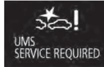
Cuando aparece la pantalla de advertencia, el sistema ultrasónico de mitigación de aceleración accidental no funciona normalmente porque hay algunos fallos en el sistema. Solicite la inspección del vehículo en un distribuidor autorizado de MITSUBISHI MOTORS lo antes posible.
