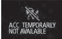
Ejemplo: el sistema de frenos se sobrecalienta debido al control continuo del freno en una larga pendiente de bajada.
