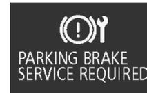
Si hay un mal funcionamiento en el sistema, se encenderá la luz de advertencia del freno de estacionamiento eléctrico. Además, la pantalla de advertencia aparece en la pantalla de información en el tablero de instrumentos.
