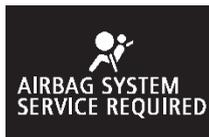
Hay una luz de advertencia del sistema de sujeción suplementario (SRS) en el tablero de instrumentos. El sistema se verifica a sí mismo cada vez que el interruptor de encendido se pone en posición "ON" (Encendido) o el modo de funcionamiento se pone en ON. La luz de advertencia del SRS se encenderá después de varios segundos y luego se apagará. Esto es normal y significa que el sistema está funcionando de forma correcta.
