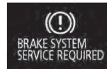
Si el líquido de frenos está bajo cuando el interruptor de encendido o el modo de funcionamiento están en ON, se muestra esta advertencia.
