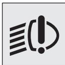
Esta luz de advertencia en el tablero de instrumentos se enciende cuando haya una falla en los faros delanteros de LED.
