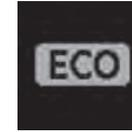
Este indicador se mostrará cuando se logre una conducción eficiente en el consumo de combustible.
