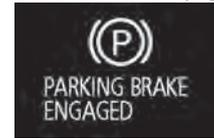
Si el freno de estacionamiento eléctrico no se puede aplicar automáticamente debido a un mal funcionamiento del sistema, el mensaje aparecerá en la pantalla de información del tablero de instrumentos. Pise el pedal del freno.
