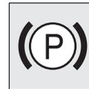
La luz se ilumina cuando se aplica el freno de estacionamiento mientras el modo de funcionamiento está en ON (Encendido).
