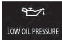
Si la presión del aceite del motor cae cuando el motor está en marcha, se muestra la pantalla de advertencia en la pantalla de información en el tablero de instrumentos.
