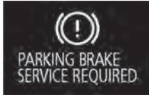
Si hay un mal funcionamiento en el sistema, se encenderá la luz de advertencia del freno de estacionamiento eléctrico (amarilla). Además, la pantalla de advertencia aparece en la pantalla de información en el tablero de instrumentos.
