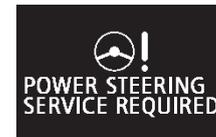
Si hay un defecto en el sistema, la luz de advertencia se encenderá y la pantalla de advertencia aparecerá en la pantalla de información del tablero de instrumentos.
