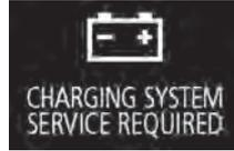
Si hay una falla en el sistema de carga, se muestra la pantalla de advertencia en la pantalla de información en el tablero de instrumentos. La luz de advertencia en el tablero de instrumentos también se enciende.
