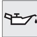
Esta luz se ilumina cuando el interruptor de encendido se gira a la posición "ON" (Encendido) y se apaga una vez que arranca el motor. Si se enciende mientras el motor
