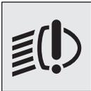
Esta luz de advertencia en el tablero de instrumentos se encenderá cuando haya una falla en los faros delanteros de LED.
