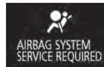
Hay una luz de advertencia del sistema de sujeción suplementario (SRS) en el tablero de instrumentos. El sistema se verifica a sí mismo cada vez que el interruptor de encendido se pone en posición "ON" (Encendido) o el modo de funcionamiento se pone en ON. La luz de advertencia del SRS se encenderá después de varios segundos y luego se apagará. Esto es normal y significa que el sistema está funcionando de forma correcta.
